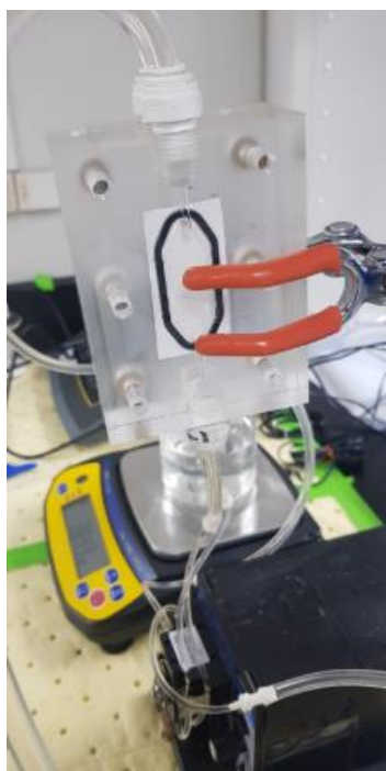
Figura 8. Placa montada en el soporte con la membrana en su interior. Foto tomada por Zulymar Vélez.
