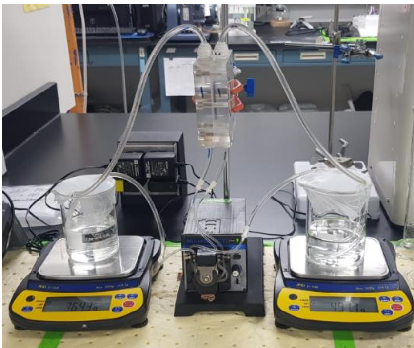
Figura 9. Filtración por membrana realizada en la UPR-RP. Foto tomada por Zullymar Vélez.
