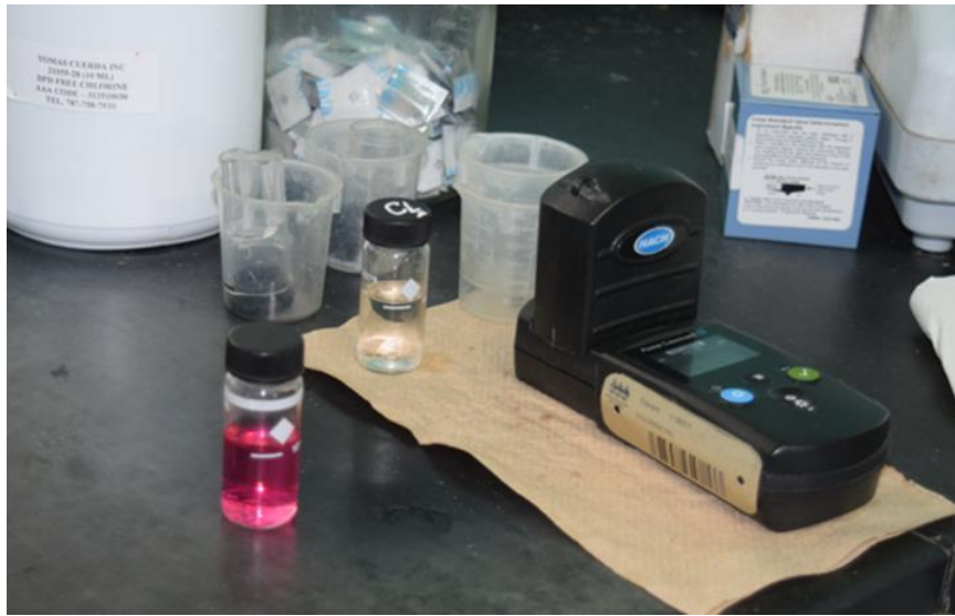
Figura 11. Instrumento colorímetro portátil “Pocket II” de la marca HACH utilizado para medir cloro libre y cloro total en las muestras (agua cruda y agua potable) y controles (agua cruda y agua potable). Foto tomada por Zulymar Vélez.
