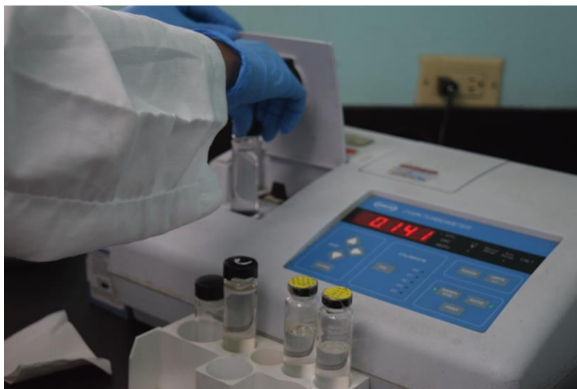
Figura 13. Turbidímetro de la marca HACH 2100N utilizado para medir turbidez en las muestras (agua cruda y agua potable) y controles (agua cruda y agua potable). Foto tomada por Zullymar Vélez.
